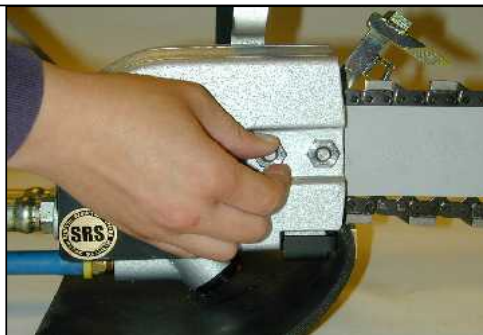
TRIN 6: Sideafdækningen monteres og møtrikkerne strammes med fingrene.
