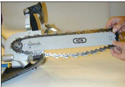
STEG 4: Kedjan sätts på svärd som börjar vid kedjehjulet och fortsätter bortom svärdets spets.
