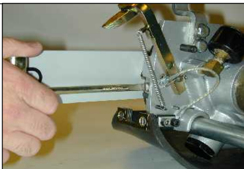
STEG 3: Flytta kedjans justeringsstift bakåt mot kedjehjulet genom att dra kedjespänningsskruven moturs.
