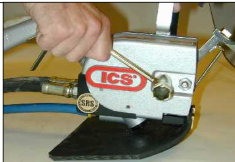
STEG 1: Lossa muttrarna på sidoskyddet och avlägsna detta.
